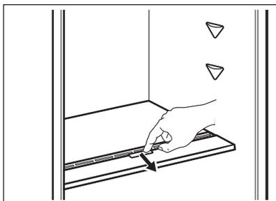
Chcete-li zařízení pro regulaci vlhkosti vyjmout, otevřete zásuvku pod skleněnou polici a vytáhněte kryt.
