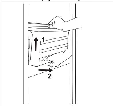
4. Zatlačte kolejničky dovnitř skříně, abyste zabránili poškození spotřebiče při zavírání dveří.
