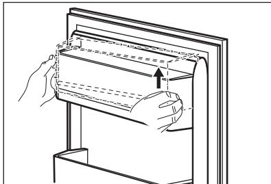
3. Tõstke ka vasak serv üles ja eemaldage riil.
