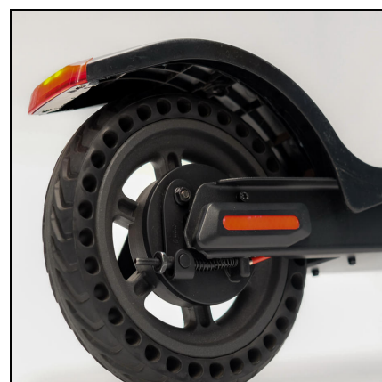
Plástvová kola odolná proti defektům
