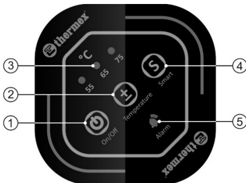
Obr. 2: 1 - Tlačítko zapnutí / vypnutí „Zapnuto / Vypnuto“, 2 - Tlačítko zvýšení / snížení teploty topení „3“, 3 - indikátory teploty ohřevu (55 ° C, 65 ° C, 75 ° C), 4 - „Tlačítko inteligentního režimu, 5 - indikátor nouzového alarmu „Alarm“.
